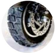
オフロードも走行可能なアドベンチャー仕様がeXs2の特徴です。10インチ大径ブロックタイヤ&前後サスペンションを装着したことで走破性を高めました。23.5kgという重量により、安定したハンドリングを実現したほか、3段階のパワー切り替えにより坂道でもパワフルな走りを楽しめます。身長に合わせてハンドルポストの高さ調整も可能です。
